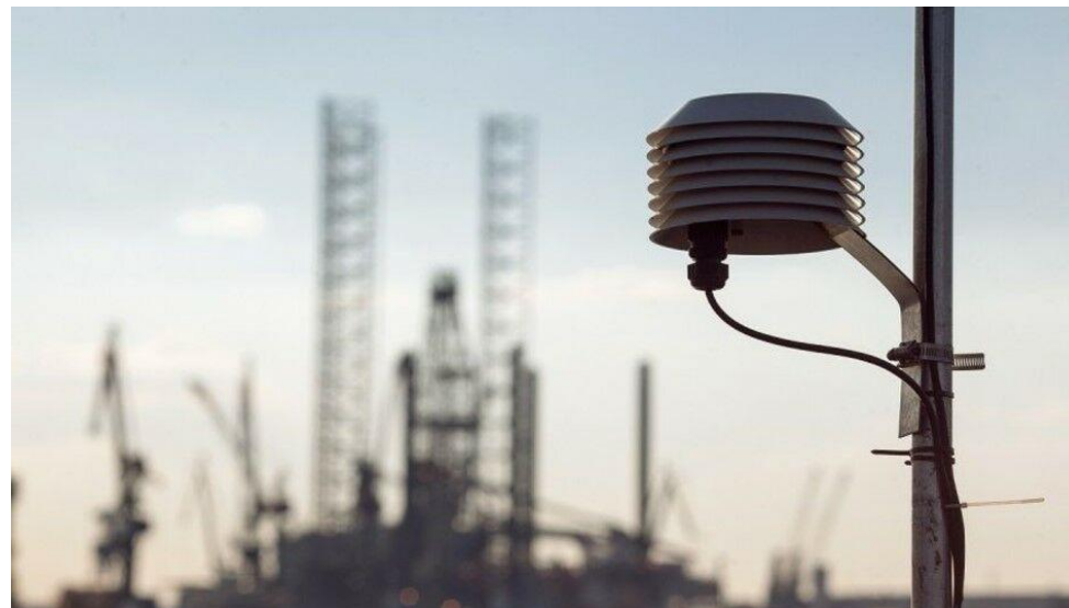
Een e-nose (elektronische neus) registreert veranderingen in de luchtsamenstelling
